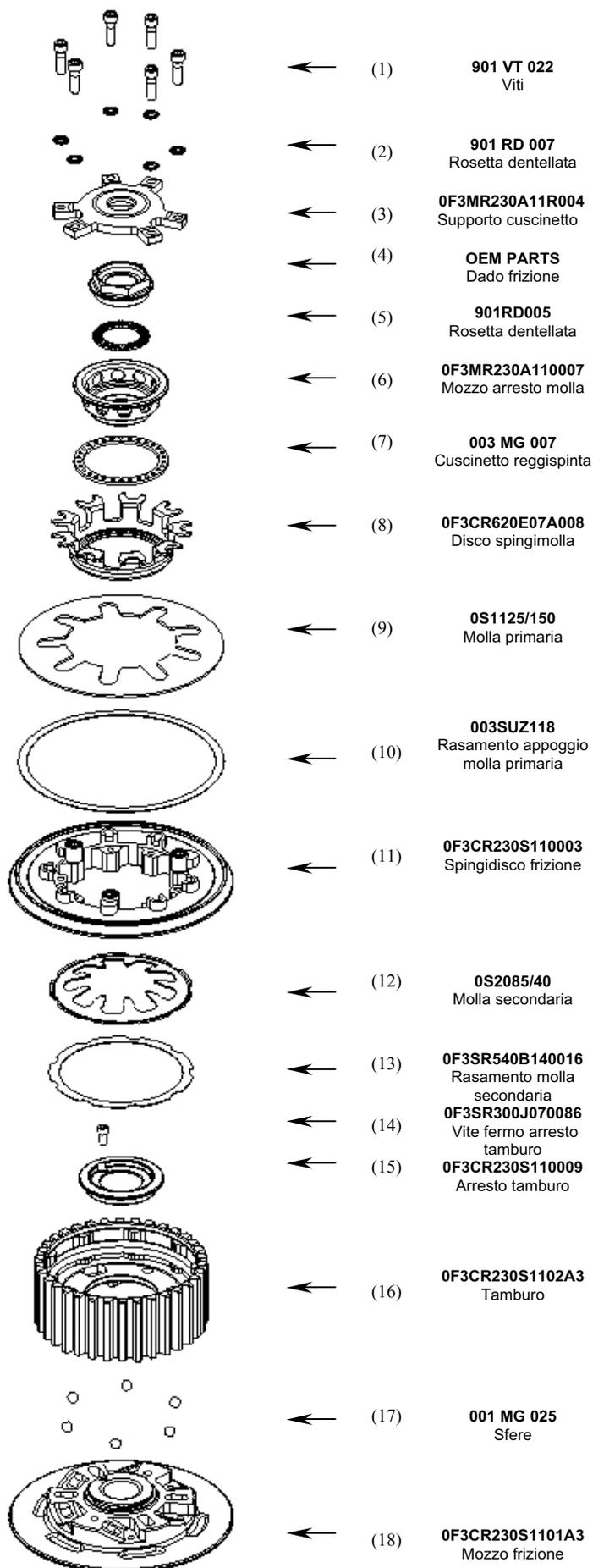
Il gruppo mozzo/tamburo, viene fornito pre-assemblato. **IN CASO DI NECESSITA'**, per eseguire una ispezione dello stato delle rampe, seguire la PROCEDURA SMONTAGGIO GRUPPO MOZZO/TAMBURO indicata più in basso.
