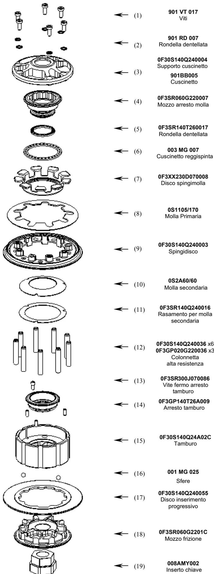
Il gruppo mozzo (18) tamburo (15), viene fornito pre-assemblato. **IN CASO DI NECESSITA'**, per eseguire una ispezione dello stato delle rampe, seguire la PROCEDURA SMONTAGGIO GRUPPO (18/15) indicata più in basso.
